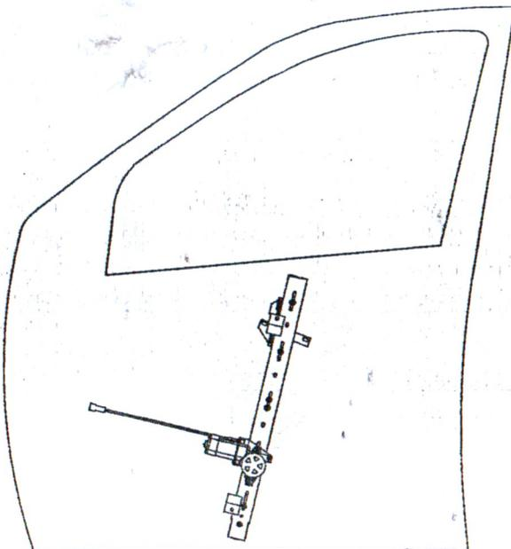
ремещения стекла контролируют пробными включениями стеклоподъемников. При необходимости гнезда в колодке меняют местами.
