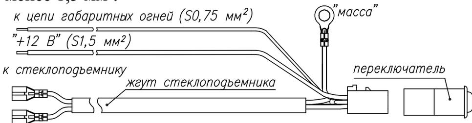
После прокладки кабелей стеклоподъемников отрезают их избыточную длину, зачищают изоляцию. На проводах кабелей стеклоподъемников обжимают гнезда и вставляют их в колодки гнездовые, проводят подключение к бортовой сети.
