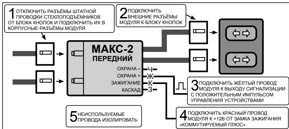
Рисунок 3. Схема подключения модуля МАКС к сигнализации с положительным импульсом на выходе управления внешними устройствами
