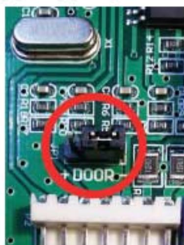
Для изменения контроля полярности входного сигнала необходимо снять крышку центрального блока сигнализации и установить перемычку в нужное положение. Заводская установка соответствует отрицательной полярности входного сигнала.
