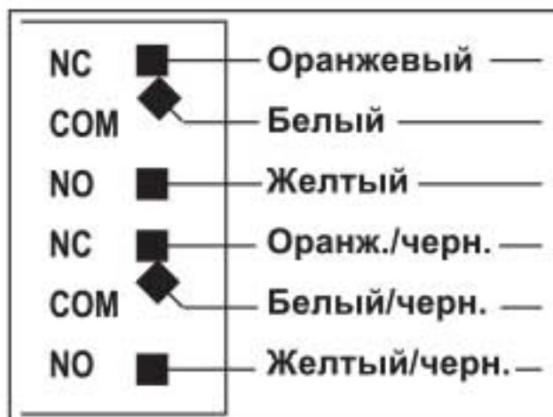
Типовая схема подключения к электрическому центральному замку
