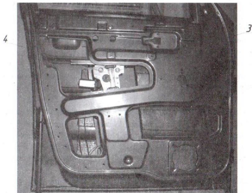
Установка ЭСП в переднюю левую дверь. рис. 1
